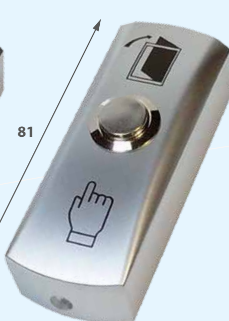
PW-42W Materiał wykonania: aluminium Dodatkowa uszczelka pomiędzy obudową a przyciskiem Wymiary: 81 x 31 x 22 mm Wyjście: NO/COM
