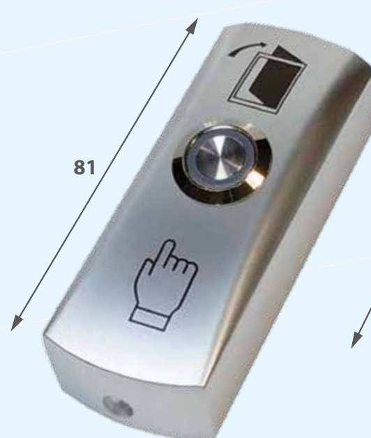
PW-42WLED Materiał wykonania: aluminium Dodatkowa uszczelka pomiędzy obudową a przyciskiem Przewody zabezpieczone żywicą Wymiary: 81 x 31 x 22 mm Podświetlenie LED Wyjście: NO/NC/COM
