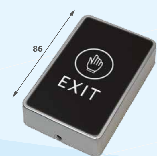
PW-C1 - Czarny Materiał wykonania: plastik Wymiary: 86 x 56 x 21 mm Podświetlenie LED Wyjście: NO/NC/COM
