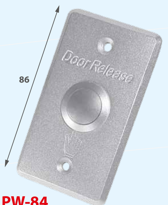
PW-84 Materiał wykonania: aluminium Wymiary: 86 x 50 mm Wyjście: NO/NC/COM
